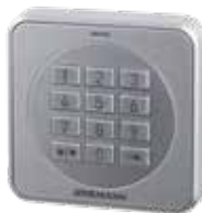
CTV 3-1 kódkapcsoló 3 funkció, különösen erős, fémbillentyűzettel, RAL 9006 fehéralumínium színű horganyöntvény házban, nemesacél blendével
